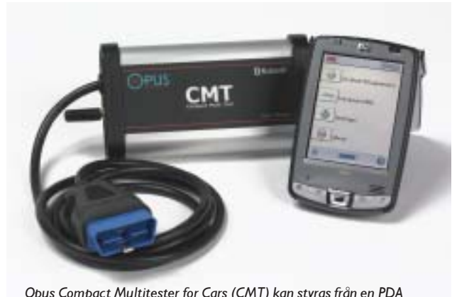
Opus Compact Multitester för Cars (CMT) kan styras från en PDA eller PC. Mjukvaran finns klar för 41 bilmärken och 17 språk.
